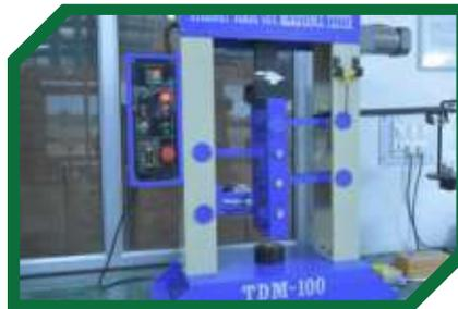
STRAIGHT BLADE CUT RESISTANCE TEST
